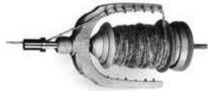
In jedem Falle muß die Spule auf der Achse sehr leicht laufen. Bei alten Spinnrädern ist die Achse oft verharzt oder verschmutzt. Sie muß gereinigt und auch während des Spinnens hin und wieder geölt werden. Auch ist es notwendig, die Achsenlagerung leichtgängig und sauber zu machen. Liegt diese in einem Holzlager, muß auch hier hin und wieder ein Tropfen Öl helfen.
